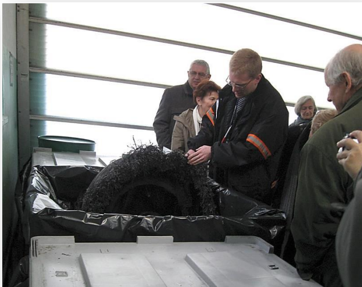
Opona całkowicie zniszczona podczas awaryjnego lądowania samolotu
